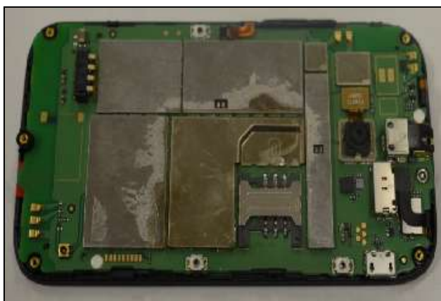
9. 将单板放到 A 壳上，注意开关机键接触。然后按紧卡扣。
