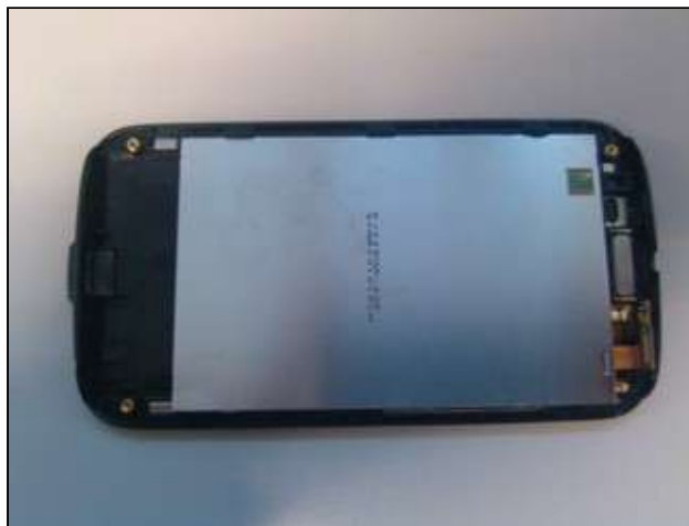
8. 组装 LCD。确保 LCD 平整，放到位。
