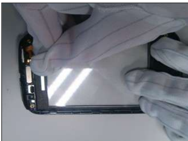
17. 在触摸屏内侧贴上保护膜。
