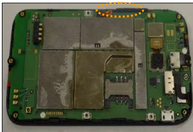
12. 组装音量键。先将音量键柔板插入到 ZIF 连接器，然后粘贴到 A 壳上。
