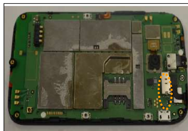
11. 松开触摸屏和 LCD 的 BTB 线。
