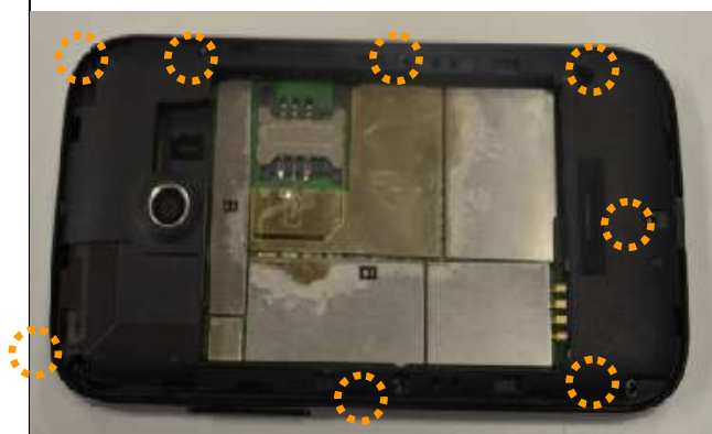
5. 拆除后壳上的 8 颗螺丝。
