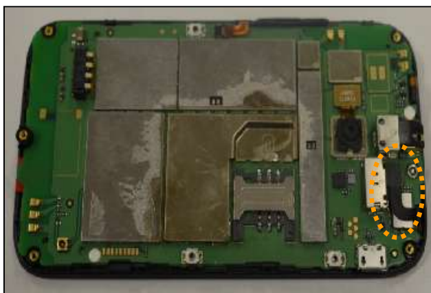
11. 扣合 LCD 的 BTB，然后再扣合触摸屏的 BTB。
