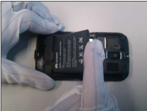
15. 安装电池，先装入底部，再装入电池仓
