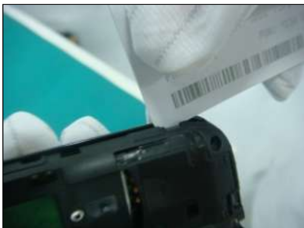
7. 用拆机拨片从上端左侧边角插入后将这个卡扣拆开。
