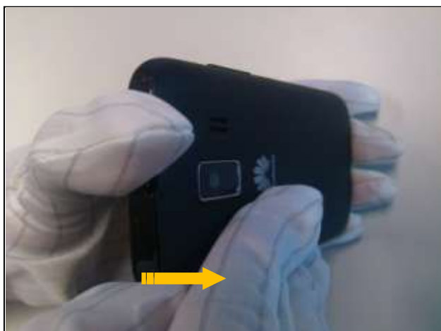
3. 拆电池盖：从上部抠手位置向后打开。
